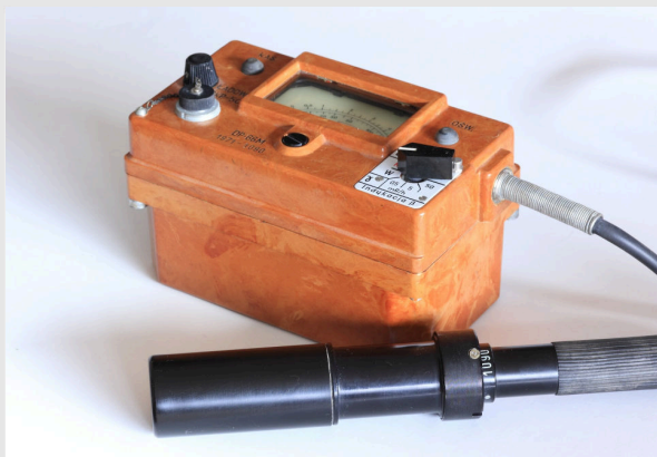
Детектор Гейгера-Мюллера с визуальным дисплеем и акустическим сигналом
